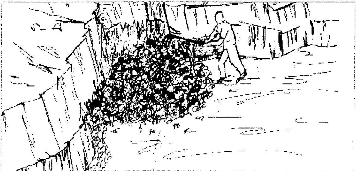
চিত্রঃ ২-৪ ডেইলি সেলের জন্য নির্ধারিত স্থানে বর্জ্য কিভাবে ছড়াতে হবে তা দেখানো হলো স্যানিটারী ল্যান্ডফিল পরিচালন ও রক্ষণাবেক্ষণ
